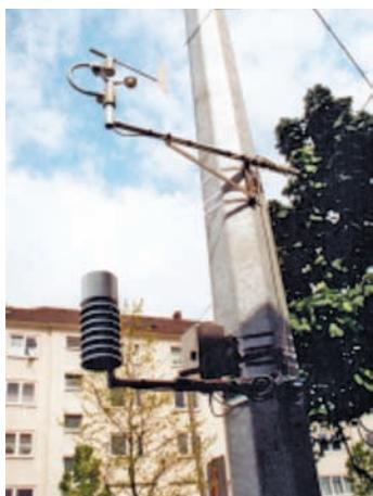
Fotografija 3. Pogled na mernu stanicu u Nordingu. Sa kombinovanim senzorom za temperaturu i vlažnost, iznad je anemometar; merač brzine vetra, a u maloj kutiji je smešten registroator u kojem se podaci digitalno obrađuju i čuvaju.
