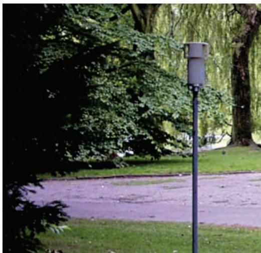
Fotografija 1. Taložni kolektor, postavljen usred Essenskog gradskog parka radi utvrđivanja količine suvih zagađivača.
